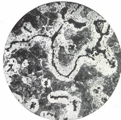
Acier au silicium (5,54 % de silicium). Employé surtout pour les dynamos et l'appareillage électrique.
